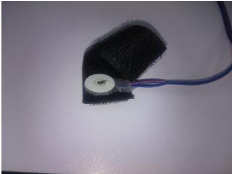
**Figura 2 En esta se muestra el material utilizado como sensor cardiaco óptico**
