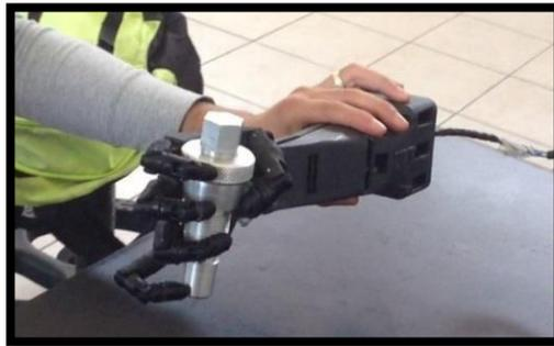
Figura 6. Prototipo levantando pieza de aluminio
