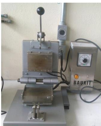
Figura 1. Prensa de termo formado para la elaboración de espumas solidas
