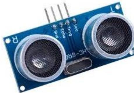
Figura 1. Sensor Ultrasónico (MaxElectrónica)
